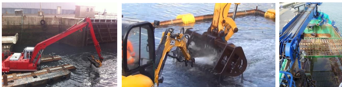
Figure 18 : Exemples de pelles équipées pour la collecte des macrodéchets et de dégrilleur sur une barge
