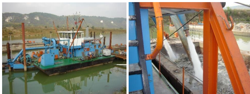
Figure 10 : Exemple de ponton refouleur (IDRA, EMCC, 2007)
